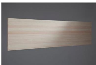
杉の柾目材を集成加工した板(2011 年 G 賞受賞「ウッドリバー」)の「桧タイプ」で新しい表現をした。森林過程で大量に生じる小径材の桧を、大口径木材の柾目使いに匹敵する綺麗な集成材にしたことで、利用価値の高い素材に仕上げた。用途は、家具、建具素材、壁面材やパーティションなどである。
