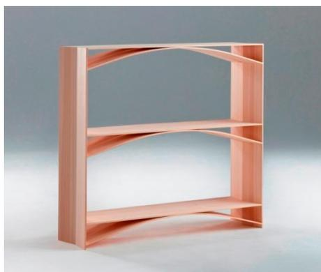
身近な資源であり素材と魅力を持つ『木』にこだわり、薄さと軽さの極限を目指した。桧の柾目材を使い板の厚さを 6 ミリの薄さにして、約 4kg にまで軽くしたことで一般の 6 段の棚と比べ約 7kg も軽く、棚の移動を容易にした。金具と合板は使わず、無垢の桧が持つ魅力とやわらかさで飾り棚を綺麗に仕上げた。洋風リビングや和室にも調和する繊細な飾り棚である。
