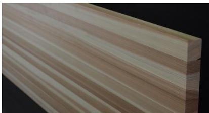
森林管理の過程で大量に生じる小径材を建具・家具に利用できないか考え、木工職人が日頃使用している建具材の柵目と同じように柵目集成にした処、大口径木材の柵目使いに匹敵する綺麗な集成材を作成しました。これにより利用価値の低い素材を、利用価値の高い素材に変え、パーティションや壁面材、家具建具など新たな用途に用いることが可能となります。
