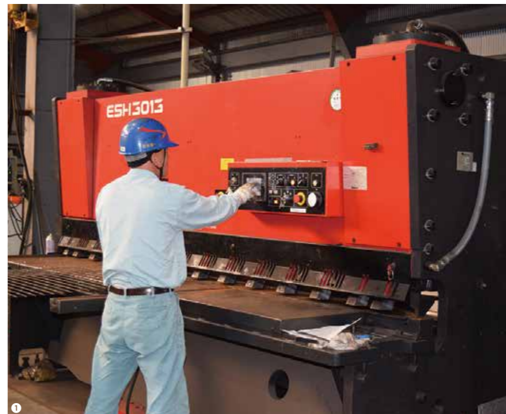
①厚さ12㎜までの鉄板が切断できる油圧式シャーリングマシン ②厚さ12㎜などの鋼材を使って製作した大型架台 ③架台の製作作業 ④製作した鋼製階段
