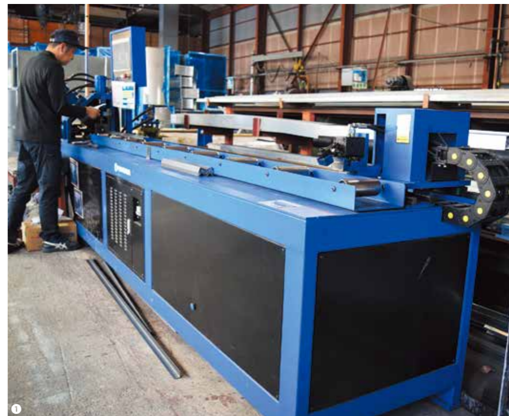
①導入したアングルフランジ穴開け切断機 ②切断や穴開けなどがなされたL字鋼のアングル4本を溶接したアングルフランジ ③先端にアングルフランジが取り付けられた角丸ダクト ④ダクトの組み立て作業風景
