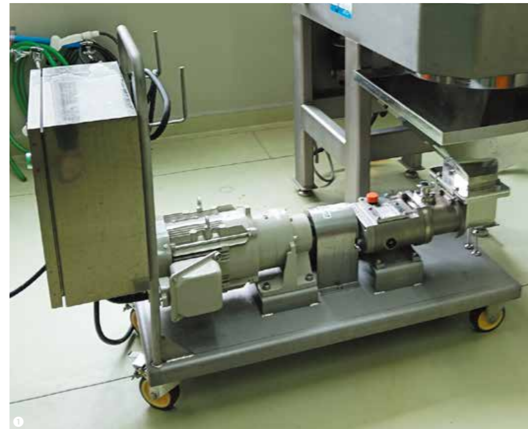
①導入したラジカルスクリュウポンプ ②加工後の有機大麦搾汁 ③大麦を収穫している様子 ④マイクロミスターの前で作業するスタッフ。原料は、下部に繋がれたスクリュウポンプで搾汁機に送られる
