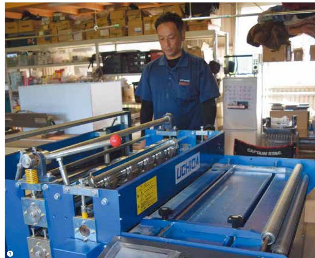
①導入した自動定尺切断機 ②切断機にロール状の板金を供給する4本ロールコイル台 ③自動切断機導入に合わせて事前購入した動力折曲機
