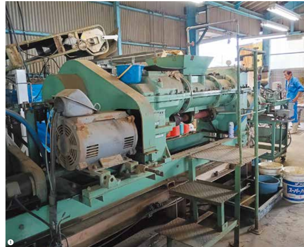
①導入した真空式土練機 ②包装機の導入でライン自動化が推進され、スタッフの業務も効率化された ③コンベアから供給された原料は、導入された真空土練機で粘土を均一に混練 ④成型・包装された発破用填塞物
