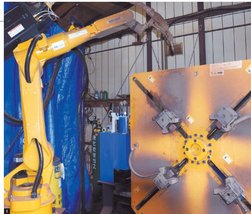
1.導入した溶接口ボット 2.溶接口ボットで溶接された柱に取り付けるための鉄骨部材 3.2015(平成27)年度補助金で導入した自動両側同時開先機
