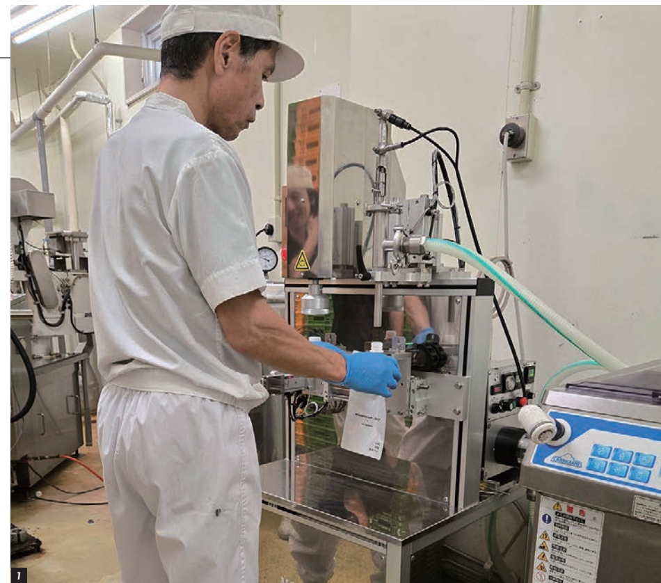
1.導入した自動充填包装機を操作する模様 2.スパウト付スタンドパウチ「メイプル牧場」「石見の朝」ヨーグルト 3.自動充填包装機とパステライザーをつないだ作業ライン 4.商品の配送準備
