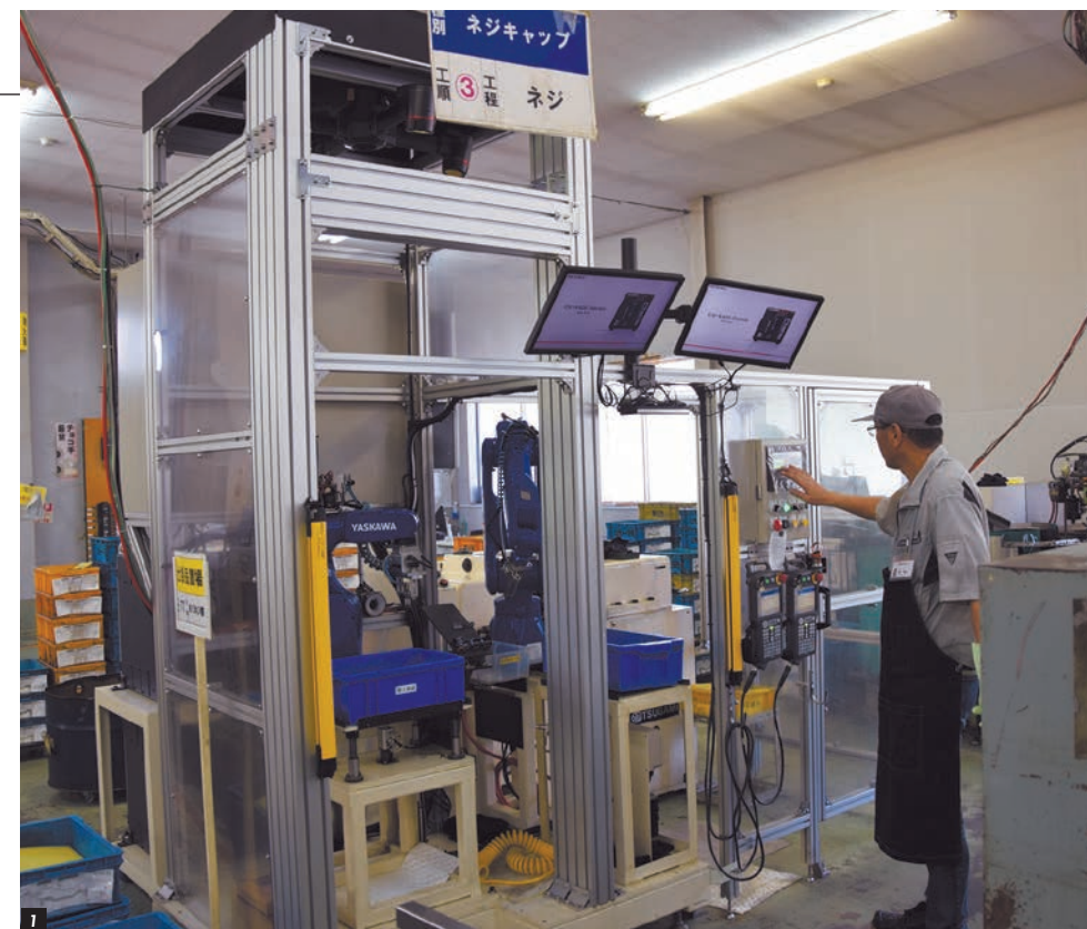
1. 転造盤ワーク供給自動化設備 2. 供給用と加工・排出用アーム 3. 3Dビジョンシステム 4. 自動化設備によって作られたネジ
