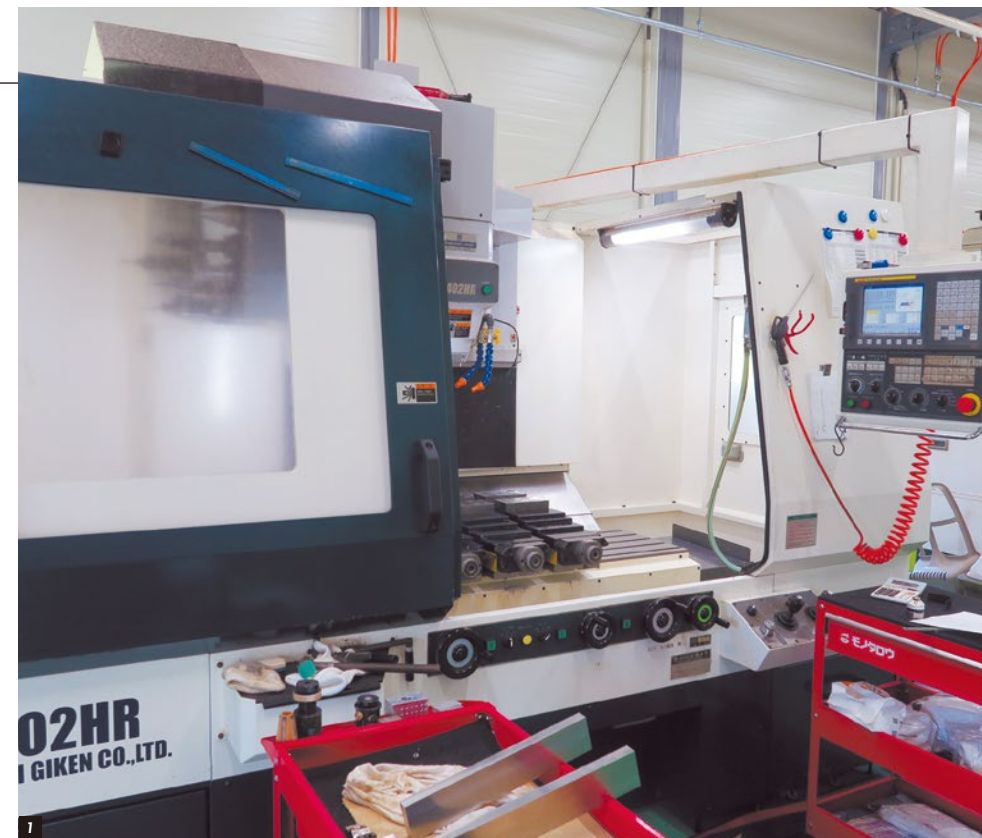
1.株式会社山崎技研立形NCフライス盤YZ-402HR 2.24本の刃物が並ぶマシニングセンタ 3.導入機械の操作パネルでプログラム操作する高田代表 4.バイクのフロントホークを固定するための部品ブラケット
