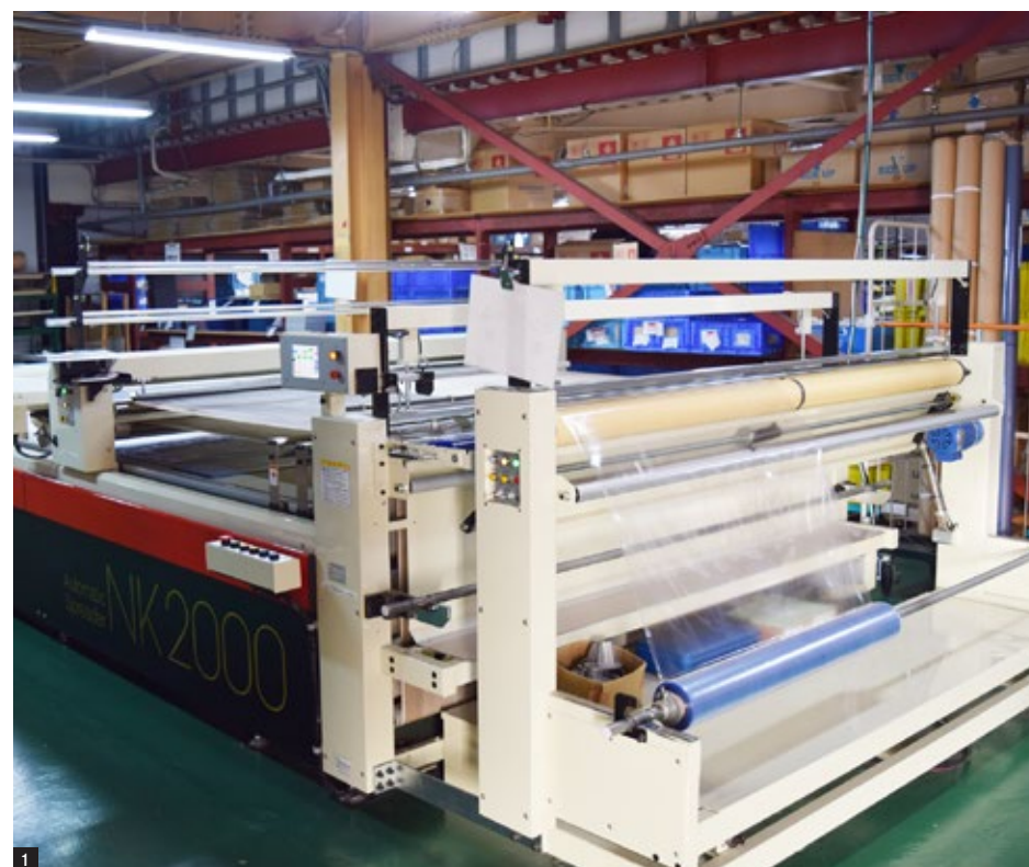
1 導入した高速定寸カットシステム
