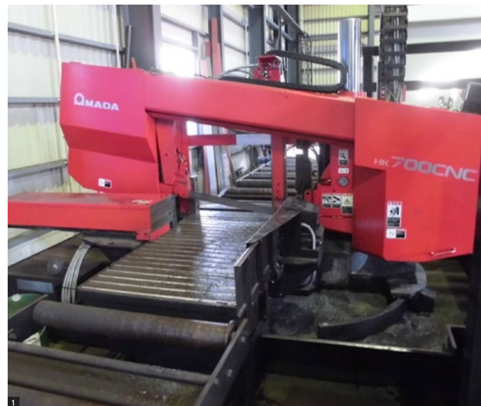
1 形鋼バンドソーの導入で角材なども製作できるように 2 ドリルマシンは使いやすく高精度の穴開けが可能 3 第二工場
