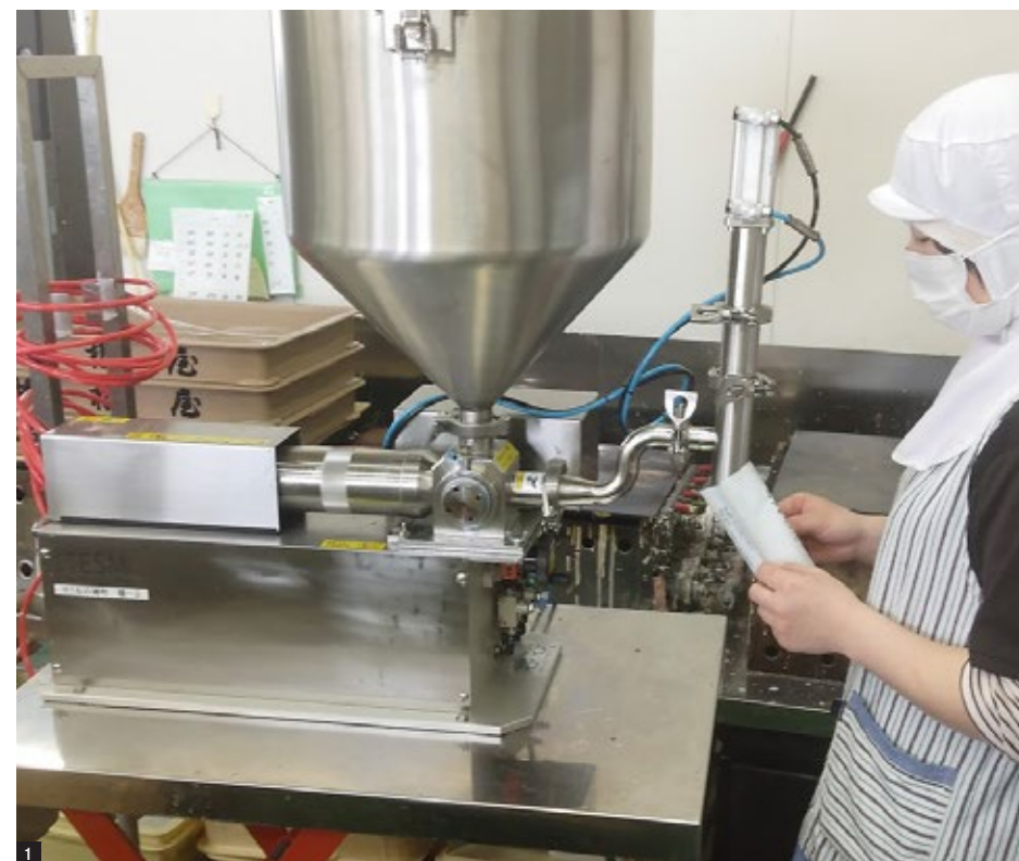
1 量産化に役立った充填機 2 導入したレトルト殺菌機(小型高温高圧調理殺菌装置 46-II型) 3 出雲ぜんざい
