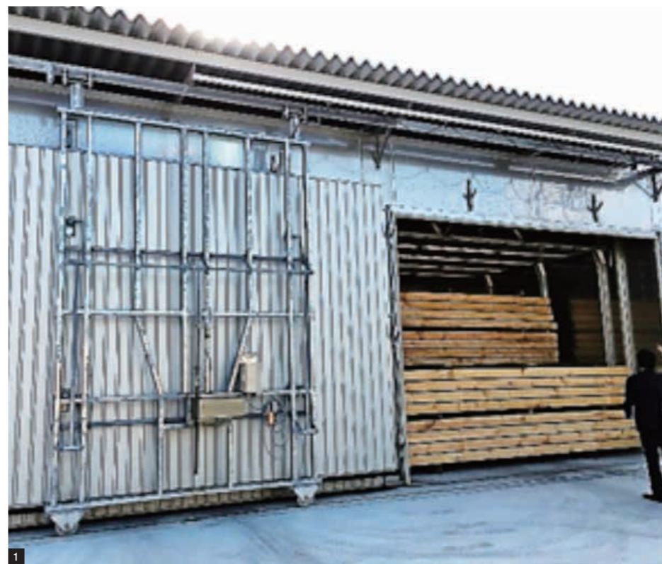
1 今回増設した木材乾燥装置 2 製材機(ツインバンドソー) 3 広い敷地での自然乾燥
