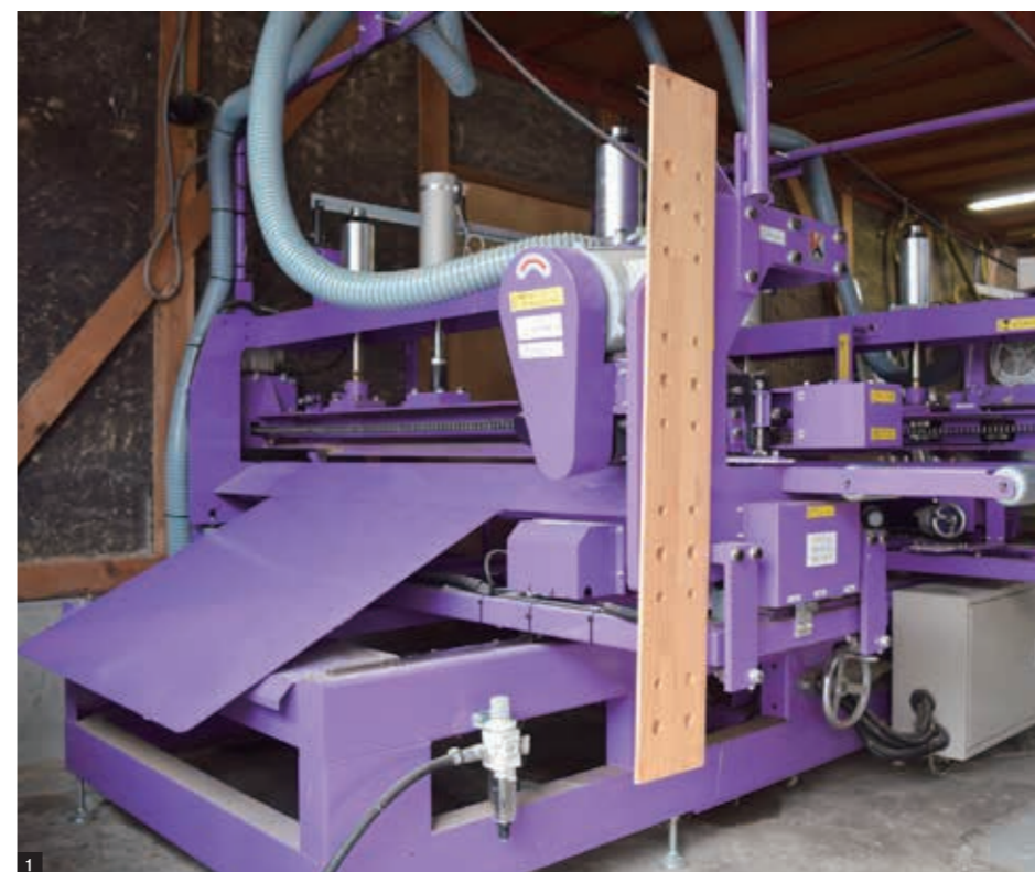
1 導入した両框裁断機チップソーⅢWIN 2 自動反転式平利し返し縫い機 3 框縫い機
