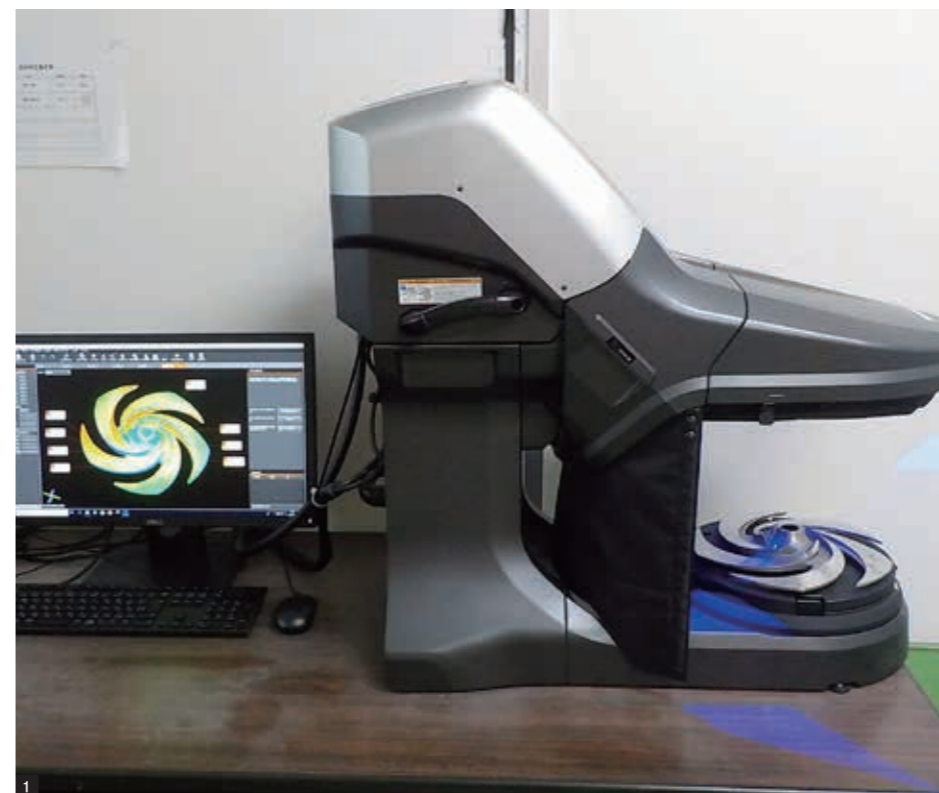
1 3Dスキャナ型三次元測定機 2 MAP型 3 MAP型断面図
