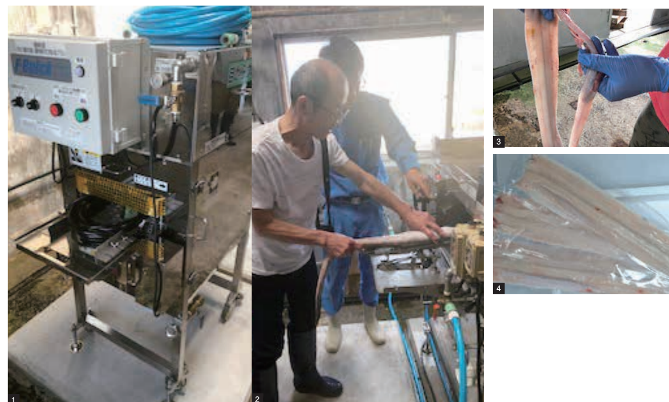
1 導入したウロコ取り機 2 導入した中骨取り開き・三枚下ろし機を使って行われるアナゴの下処理 3 下処理されたアナゴ 4 真空パックしたアナゴ
