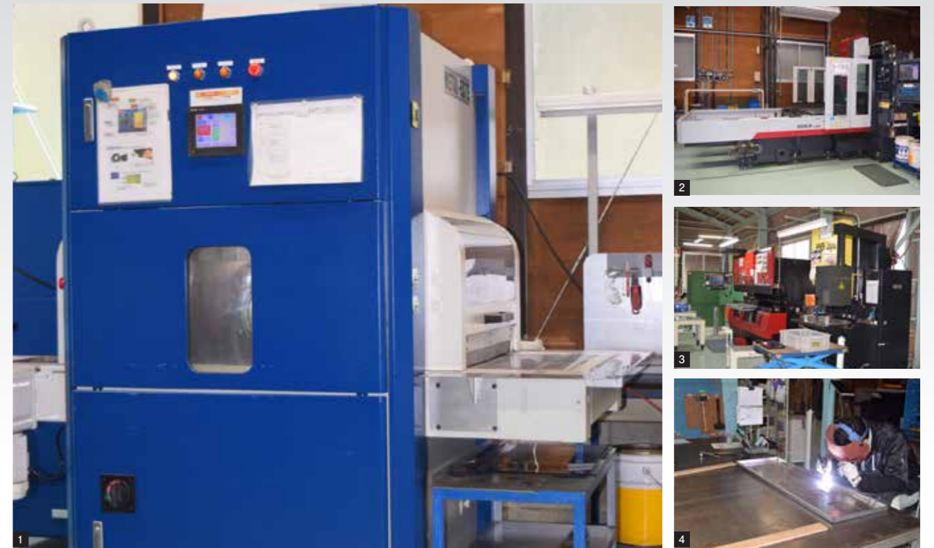
1 導入したバリ取り器 2 レーザー加工機 3 プレスブレーキ 4 溶接の様子
