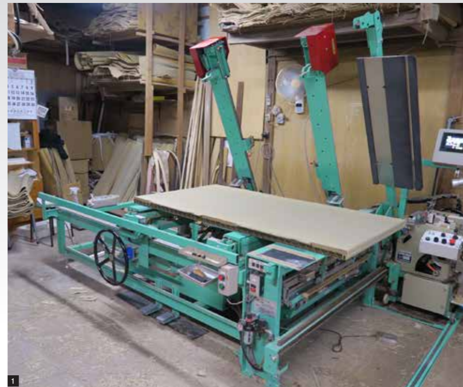
1 導入したエア一式両框裁断機付框縫機 2 稼働する全自動反転式平刺機 3 製造工場の様子
