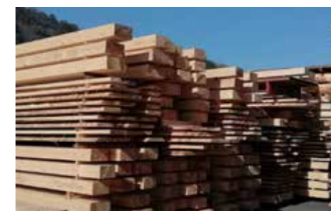
丁寧に積み上げた天然乾燥中の木材
