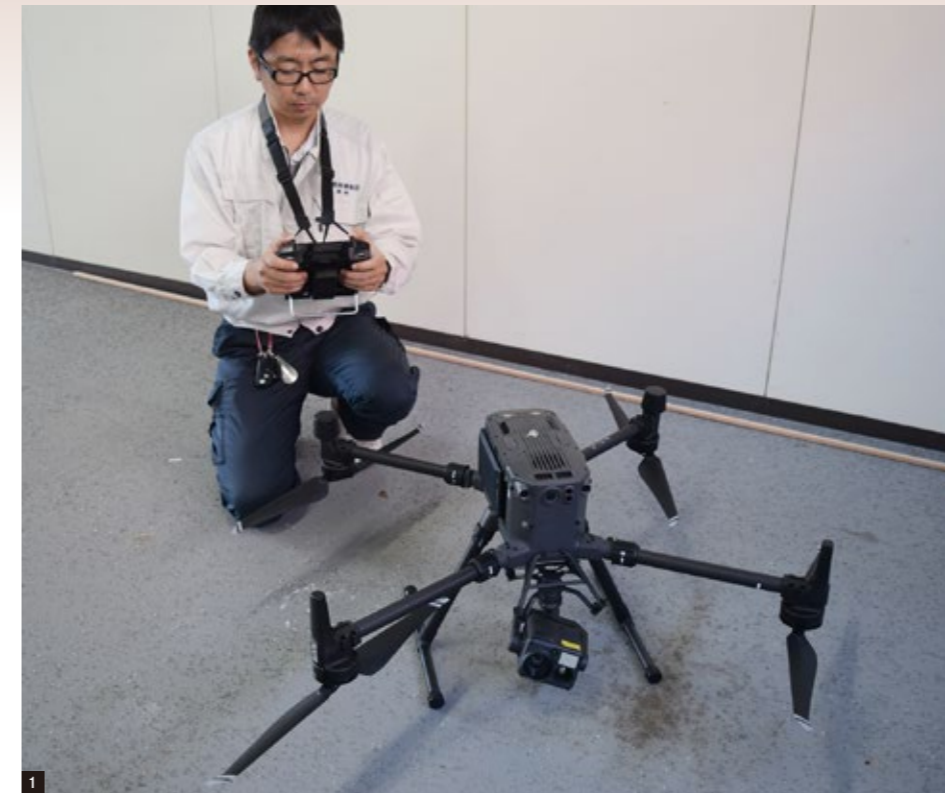
1 導入した赤外線カメラ搭載の産業用ドローン 2 ドローンによる外壁劣化調査 3 ドローンと合わせて導入した地上用赤外線カメラ 4 足場を組み立てて行う外壁劣化調査
