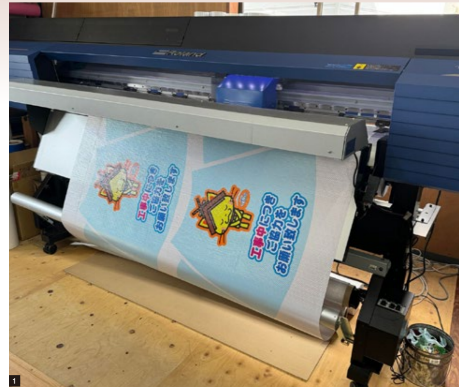
1 導入したRoland製 TrueVIS VG2-640 2,3 導入したインクジェットプリンターで印刷したステッカー商品
