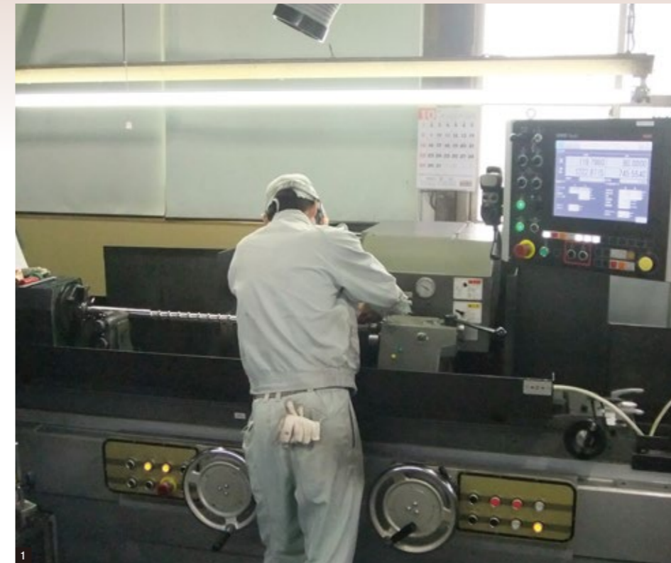
1 加工能力がアップしたCNC円筒研削盤 2,3 鏡面バフ研磨作業
