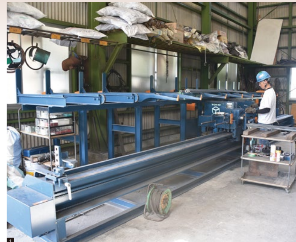
1 鉄筋自動曲装置で複雑な加工が一気に可能に 2 用途に合わせて、様々な形状に曲げられた鉄筋
