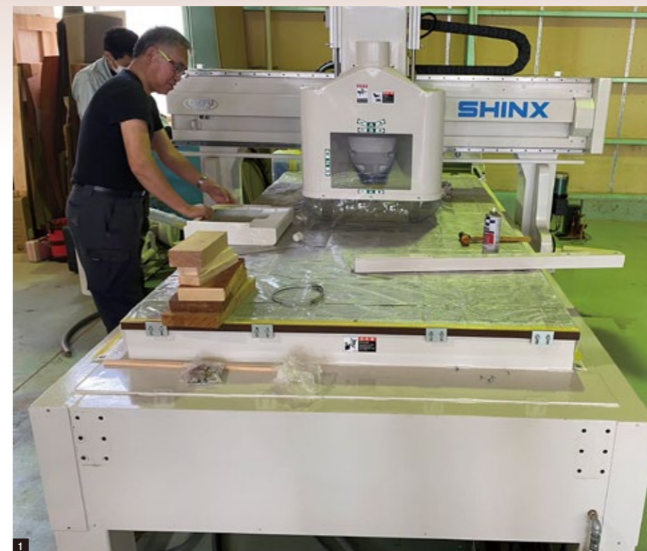
1 導入したNC5軸制御ルーター 2 操作風景 3 傾斜加工も可能に 4 不適格材のバットを再利用
