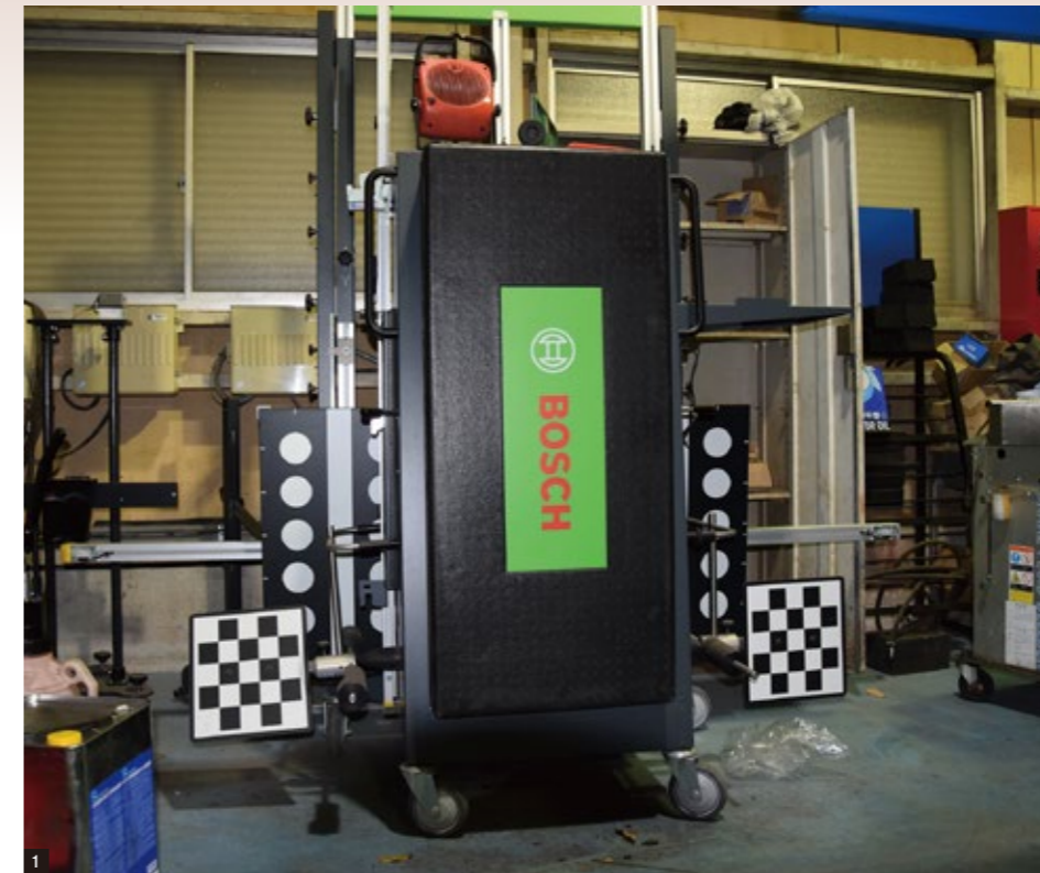
1 電子制御装置の作動を確認するエーミングDAS3000 2 ホイールの取り付け状態を見るJhon BeanアライメントテスターV3400 3 フラット・ワークステージ4t アライメント仕様 4 ホイール洗浄機RW301
